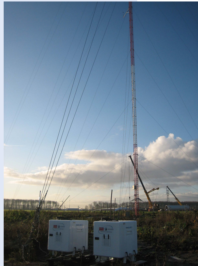
WINDCUBE v2 Lidars on ECOFYS IELYSTAD testsite, Netherlands
