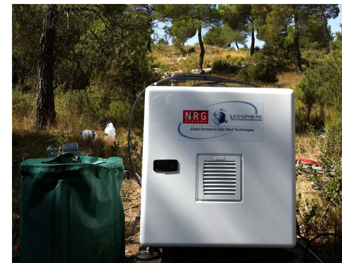
WINDCUBE v2 on Barlovento Recursos & Acciona Energia site, Valencia Region, Spain
